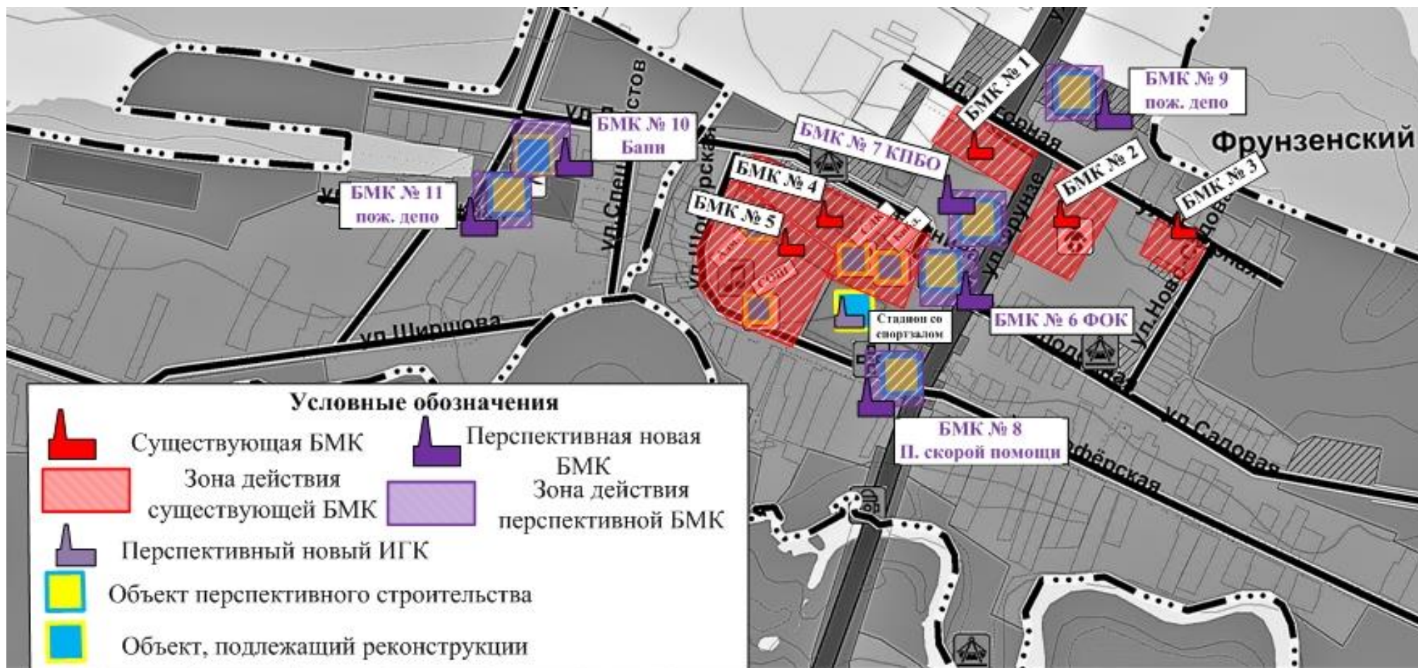
Рис. № 24 - Перспективные зоны теплоснабжения от существующих котельных и блочно-модульных источников тепловой энергии, планируемых к размещению на территориях поселка Фрунзенский и села Морша
