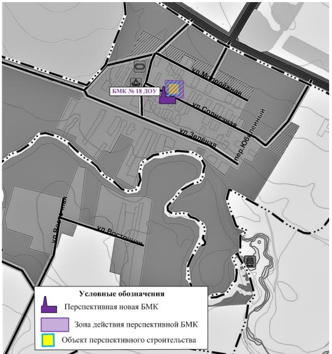
Рис. № 12 - Перспективная зона теплоснабжения от планируемой БМК на территории поселка Малый Каралык
